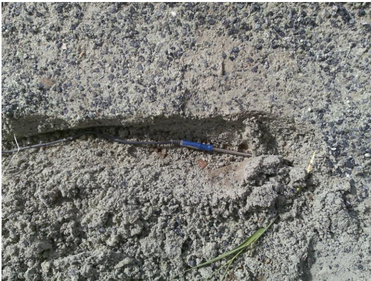
Figuur 5: Ingraven van de temperatuurmeters onder de proefpaden
