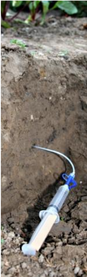
Figuur 10: Spuitgedeelte van de Rhizon-meter
