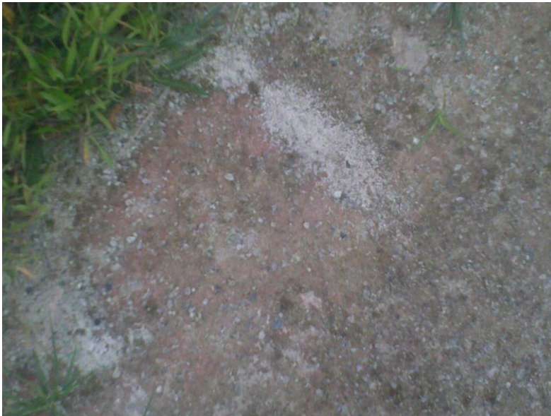
Figuur 23. Close up van proefvak 6 (100% olivijn) d.d. jun 2012. Het lichtgrijze materiaal is magnesiet.
